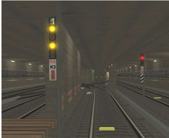
Das Signalbild von K3 ist ein Hp4 mit Zs2: zwei gelbe Lichter und eine „1“, dies bedeutet: „Mit max. 25 km/h auf Sicht aus der Kehre nach Gleis 1 fahren“.
